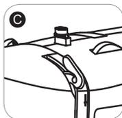
1. Pour débuter, faites tourner le volant vers vous (A) jusqu'à ce que l'aiguille soit dans sa position la plus haute (B) ainsi que le releveur de fil (C). Vous devriez apercevoir le releveur de fil.
